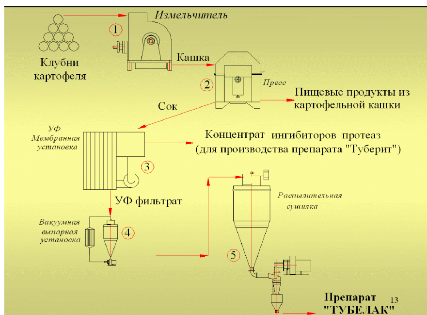
Рисунок 1 – Аппаратурно-технологическая схема установки для производства биостимулятора и средства защиты растений из картофельного сока
