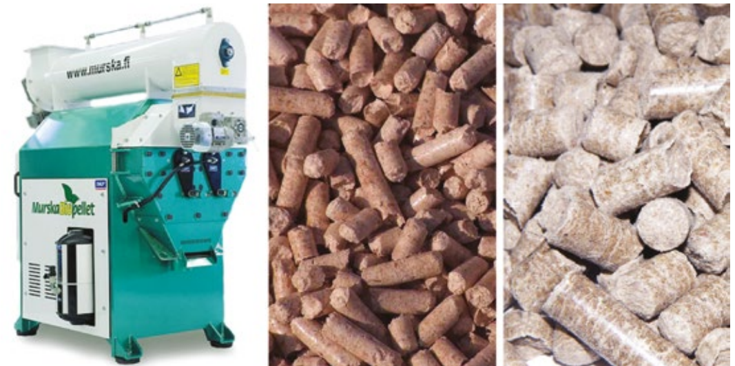
Фото 4.1. Агрегат для производства топливных пеллет фирмы Murska Biopellet (Финляндия) производительностью 0,5–2 т/ч энерго-пеллет и внешний вид пеллет из разных видов биомассы.
