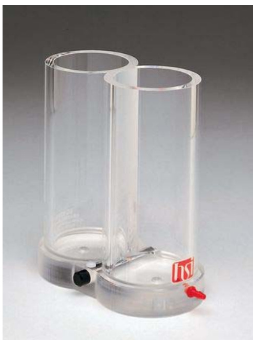
А. Градиент-мэйкер (смеситель) для создания гелей с градиентом концентрации ПАА
